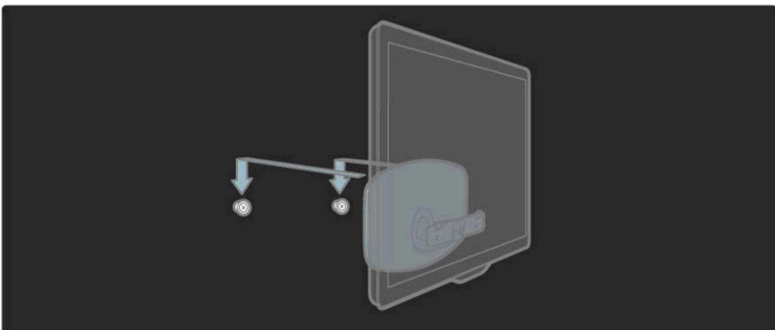
Televizor vyrovnejte mírným zatažením za spodní část televizoru směrem k sobě a nechte jej sklouznout na disky.
