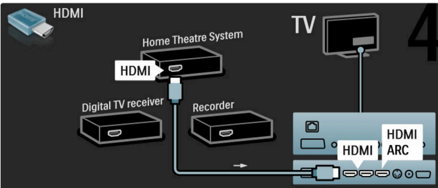
Nepoužíváte-li u televizoru a zařízení připojení HDMI-ARC, použijte digitální audio kabel (cinch, koaxiální).
