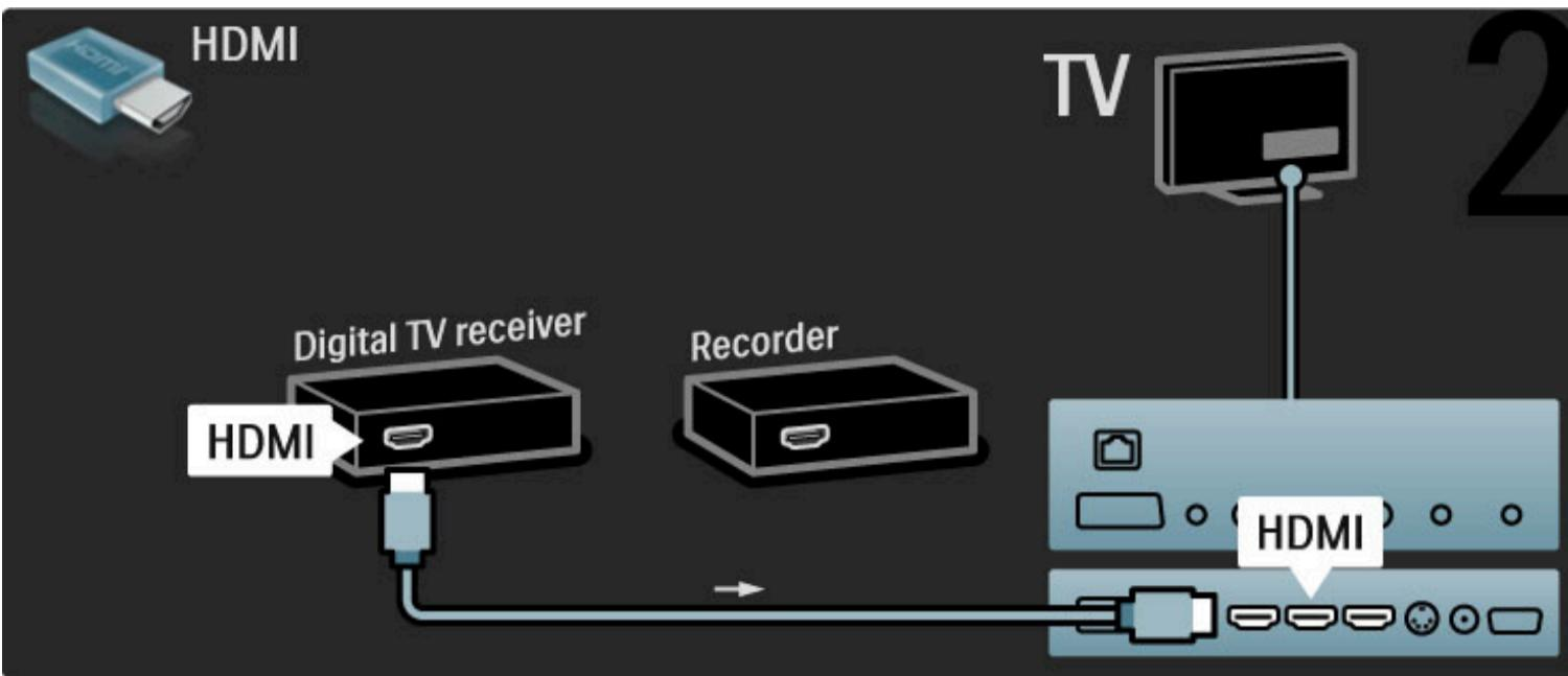
Nakonec pomocí kabelu HDMI připojte k televizoru diskový rekordér.
