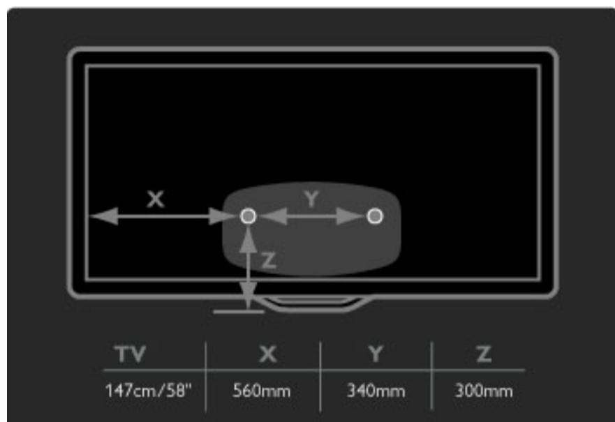
Upevnite 2 montážne disky. Použite skrutky s priemerom max. 6 mm.
