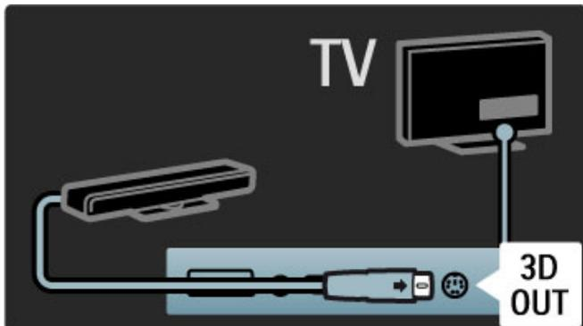
3 Instale el transmisor 3D en la parte superior o en la parte inferior del televisor. Asegúrese de que el transmisor apunta directamente al sitio en el que se sienta para ver la televisión.
