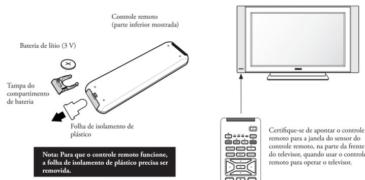
Certifique-se de apontar o controle remoto para a janela do sensor do controle remoto, na parte da frente do televisor, quando usar o controle remoto para operar o televisor.
