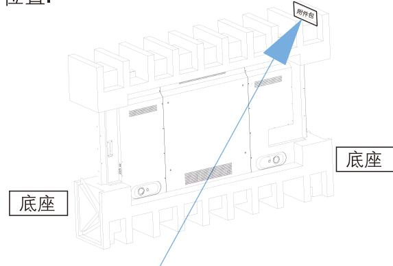
注：附件包贴在机器的塑料袋/塑料膜，放置在底部珍珠棉上（\*附件包内包含：说明书、快速安装指南、保修卡、遥控器、电池、螺丝）。
