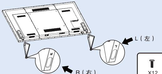
\* 从纸箱内取出左,右底座,与整机上螺钉孔位一一对应好后,再从附件袋取出螺钉将底座与整机固定好。(注意区分左右支撑, "R""L"底座上有标识)
