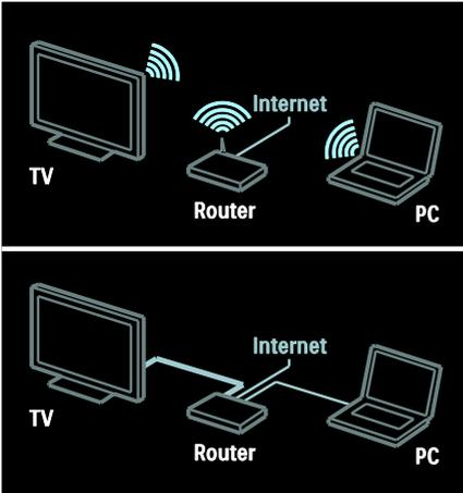
Sie können diesen Fernseher per WLAN oder per Kabel an Ihr Heimnetzwerk anschließen.
