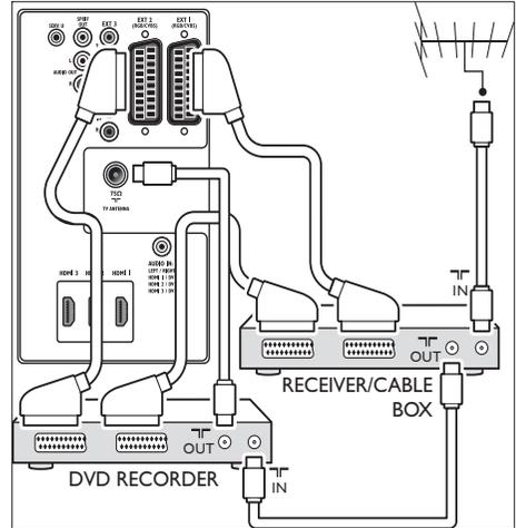
Schließen Sie zum Empfang analoger Sender über die Antenne und zur Aufnahme von Programmen auf dem getrennten DVD-Recorder und Receiver wie in der Abbildung dargestellt drei Antennenkabel und drei SCART-Kabel an:
