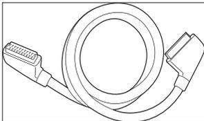
Bei SCART sind Video- und Audiosignale in einem Kabel kombiniert. Die Audiosignale sind in Stereo- und die Videosignale in Composite oder S-Video-Qualität. SCART unterstützt
