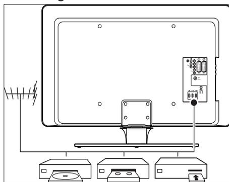
Verwenden Sie die Anschlüsse auf der Rückseite des Fernsehgeräts, um die Antenne und feste Geräte wie HD-Disc-Player, DVD-Player oder Videorecorder (siehe 'Anschließen von Geräten' auf Seite 43) anzuschließen.
