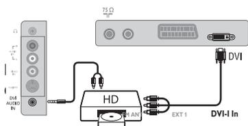
Выполните подключения, как показано на рисунке. Выберите положение **HD** с помощью кнопки **AV**. Более подробную информацию об использовании режима **HD** см. на стр. 11.
