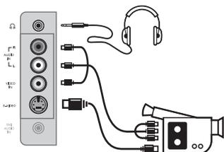
Выполните подключения, как показано на рисунке. Выберите положение **AV/S-VHS** с помощью кнопки **AV**. На монофоническом аппарате подключите звуковой сигнал к входу **AUDIO L** (или **AUDIO R**). Звук автоматически воспроизводится левым и правым громкоговорителями телевизора.
