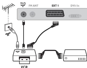
Осуществите указанные на рисунке подключения. Используйте шнур "перитель" хорошего качества. Если у вашего видеомагнитофона нет разъема перитель (или если этот разъём уже занят другой аппаратурой), то возможна лишь связь через кабель антенны. В этом случае вы должны найти тест-сигнал вашего видеомагнитофона и присвоить ему номер программы 0 (см. ручное запоминание, стр. 6). Для воспроизведения изображения видеомагнитофона нажать на клавишу 0.
