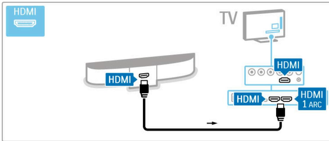
หากคุณใช้การเชื่อมต่อ HDMI-ARC บนทีวีและอุปกรณ์ ไม่จำเป็นต้องใช้สายเคเบิลอื่น หากไม่ใช้การเชื่อมต่อ ให้อ่านรายละเอียด
