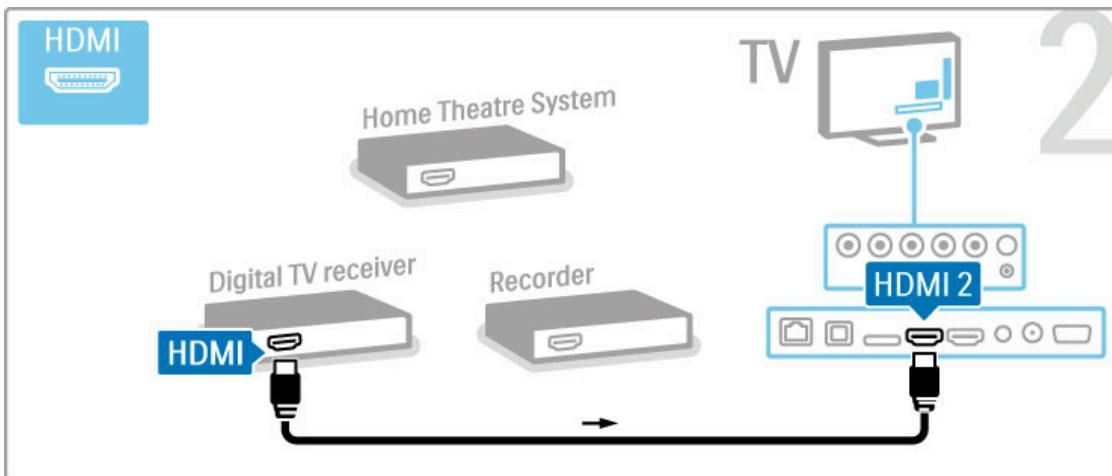
จากนั้น ใช้สาย HDMI เชื่อมต่อเครื่องบันทึกแผ่นดิสก์กับทีวี
