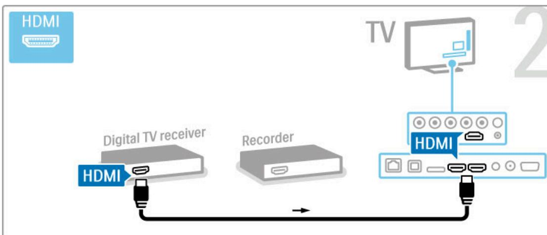
สุดท้าย ให้ใช้สาย HDMI เชื่อมต่อเครื่องบันทึกแผ่นดิสก์กับทีวี
