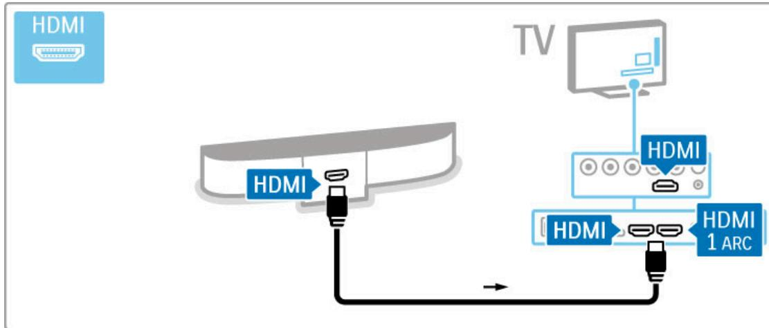
หากคุณไม่ใช้การเชื่อมต่อ HDMI-ARC ให้เพิ่มสายสัญญาณเสียงดิจิตอล (ออปติคัล)
