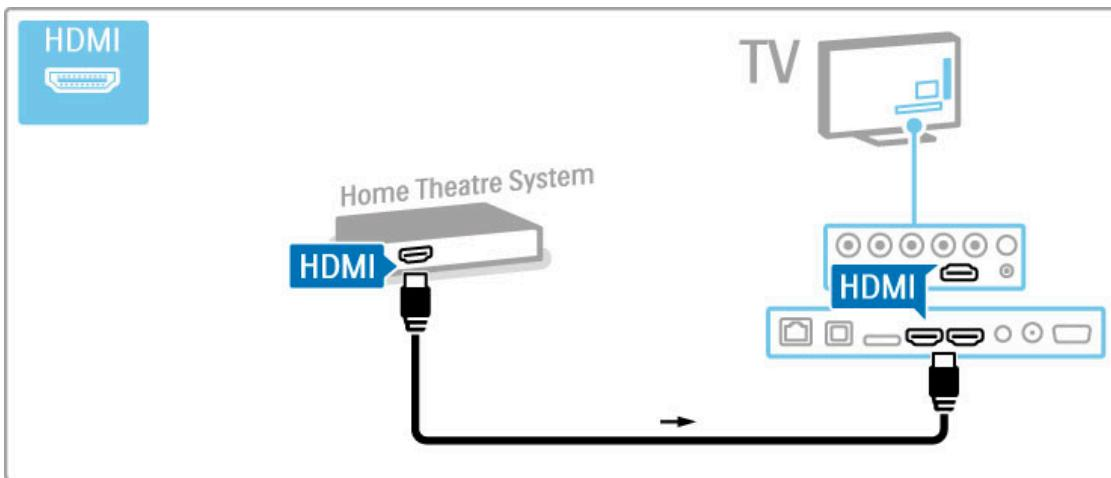
หากคุณใช้การเชื่อมต่อ HDMI-ARC บนทีวีและอุปกรณ์ ไม่จำเป็นต้องใช้สายเดbel อีก หากไม่ใช้การเชื่อมต่อ ให้อ่านรายละเอียด
