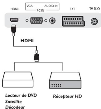
Conformité de l'entrée HDMI avec la capacité de gestion des signaux 480i/p, 576i/p, 720p, 1080i/p.
