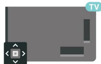
1 - Con el televisor encendido, pulse el botón con el símbolo de joystick de la parte posterior del televisor para ver el menú básico.
