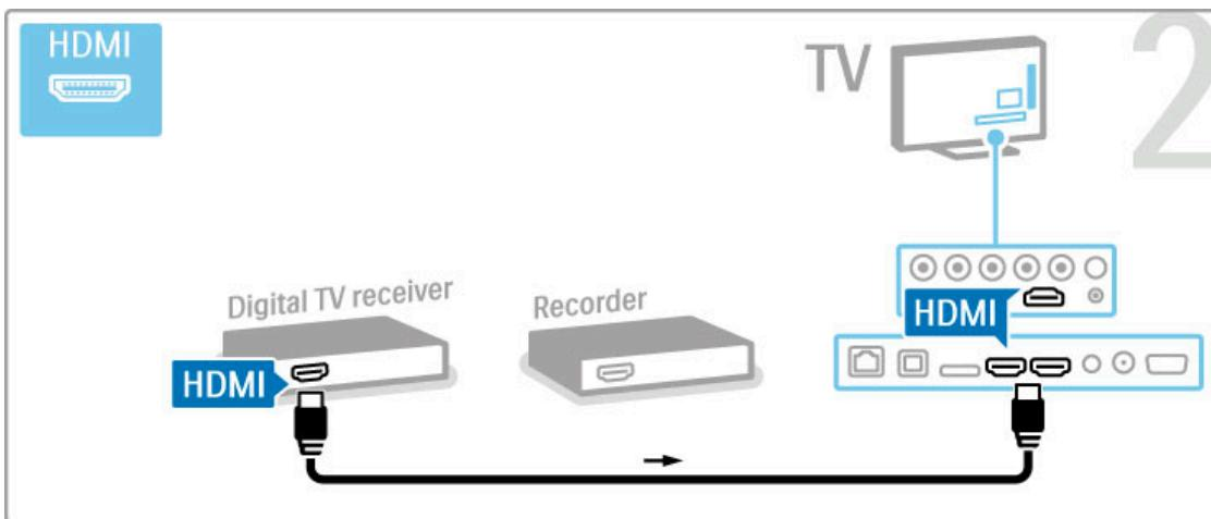
С помощью кабеля HDMI подключите к телевизору устройство записи дисков.
