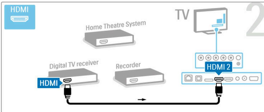
Затем с помощью кабеля HDMI подключите к телевизору устройство записи дисков.
