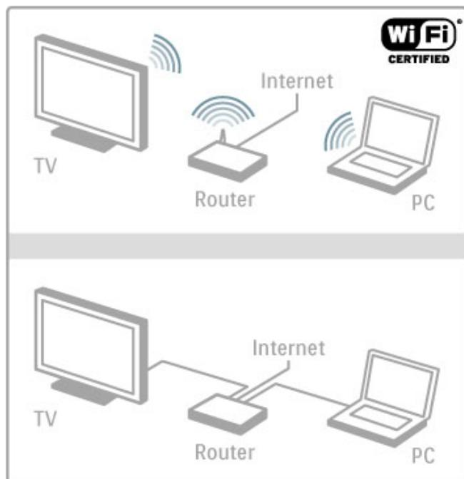
Для проводного подключения к маршрутизатору требуется сетевой кабель (Ethernet).
