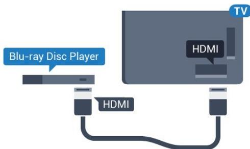
Nếu Đầu đĩa Blu-ray có EasyLink HDMI CEC, bạn có thể điều khiển đầu đĩa bằng điều khiển từ xa của TV.
