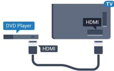
Nếu đầu phát DVD được kết nối với HDMI và có EasyLink CEC, bạn có thể điều khiển đầu đĩa bằng điều khiển từ xa của TV.
