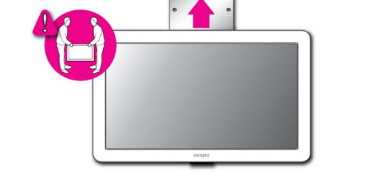
**iii** Carefully mount the TV straight onto the wall mount hook. Do not angle the TV onto the hook. A 'click' sound indicates that the TV is correctly mounted and locked into place. Montare attentamente il televisore sul gancio del supporto a parete in posizione dritta. Non inclinare il televisore sul gancio. Un clic indica che il televisore è stato montato correttamente.
