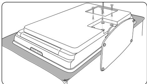
3. Sfilare in modo fermo il supporto dalla parte inferiore del televisore. Riporre sia il supporto che le viti in un posto sicuro affinché possano essere utilizzati in futuro.
