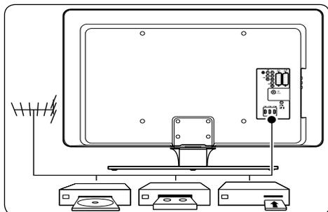
Utilizzare i connettori posteriori del televisore per collegare l'antenna e dispositivi fissi quali un lettore di dischi ad alta definizione, un lettore DVD o un videoregistratore.
