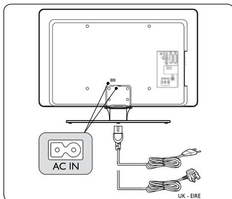
1. Individuare il connettore di alimentazione principale **AC IN** sul retro o nella parte inferiore del televisore.
