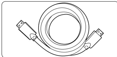
HDMI garantisce la migliore qualità audiovisiva. Entrambi i segnali audio e video sono combinati in un unico cavo HDMI offrendo un'interfaccia digitale non compressa tra il televisore e i dispositivi HDMI. Per sperimentare appieno la tecnologia video ad alta definizione è necessario utilizzare l'interfaccia HDMI. Per attivare Philips EasyLink è necessario utilizzare anche i cavi HDMI come descritto nella *Sezione 7.5 Utilizzare Philips EasyLink*.
