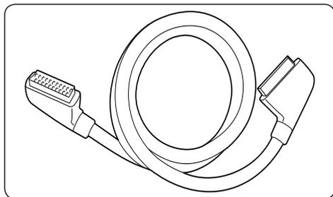
La tecnologia SCART combina segnali audio e video in un unico cavo. I segnali audio sono stereo, mentre i segnali video possono essere di qualità Composite o S-Video. La tecnologia SCART non supporta video ad alta definizione ed è analogica. Il televisore ha due connettori SCART, EXT 1 e EXT 2.
