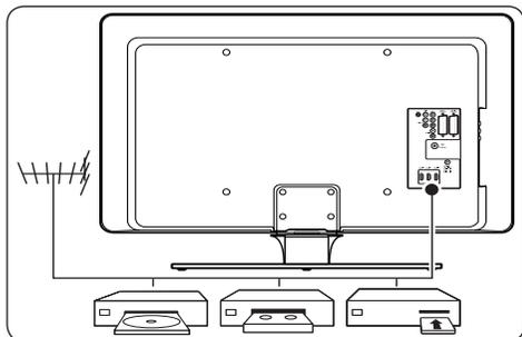
Utilize os conectores posteriores do televisor para estabelecer ligação à antena e dispositivos permanentes, como um leitor de discos de Alta Definição, um leitor de DVD ou um videogravador.
