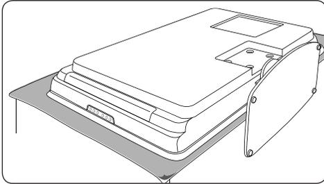
2. Com uma chave de estrelas (não fornecida), desaparafuse os quatro parafusos que fixam o suporte ao televisor.
