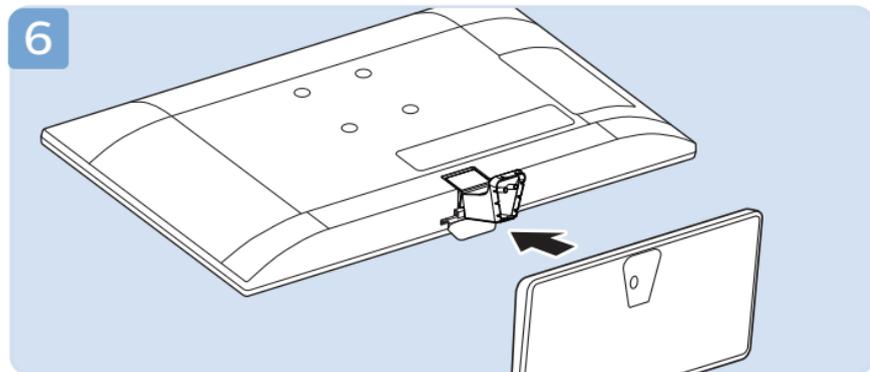
\*将底座中间突出位置按照图示对准支架。
