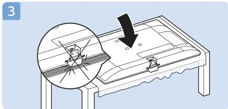
\*请将电视机底部边缘靠近台面边缘，将下巴放置于台面外。
