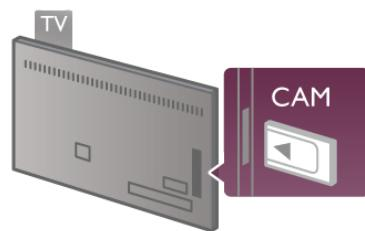
Χρησιμοποιήστε την υποδοχή κοινής διασύνδεσης στην αριστερή πλευρά της τηλεόρασης, για να εισαγάγετε την κάρτα CAM\*. Εισαγάγετε απαλά τη μονάδα CAM μέχρι τέρμα και αφήστε την μόνιμα στην υποδοχή. Ισως περάσουν μερικά λεπτά μέχρι να ενεργοποιηθεί η μονάδα. Αν αφαιρέσετε τη μονάδα CAM, η υπηρεσία μετάδοσης στην τηλεόραση θα απενεργοποιηθεί.
