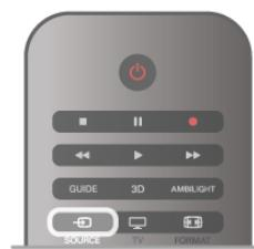
Αφού επιλέξετε τη συσκευή, μπορείτε να χρησιμοποιήσετε το τηλεχειριστήριο της τηλεόρασης για να τη χειριστείτε. Ωστόσο, οι εντολές των πλήκτρων (Αρχικό μενού) και **OPTIONS**, καθώς και ορισμένων άλλων πλήκτρων τηλεόρασης, όπως το **Ambilight**, δεν προωθούνται στη συσκευή.
