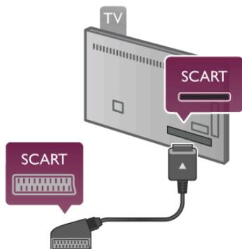
Χρησιμοποιήστε το παρεχόμενο καλώδιο SCART για να συνδέσετε τη συσκευή σας.
