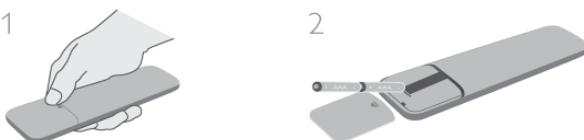
Αφαιρέστε τις μπαταρίες, εάν δεν πρόκειται να χρησιμοποιήσετε το τηλεχειριστήριο για μεγάλο χρονικό διάστημα.
