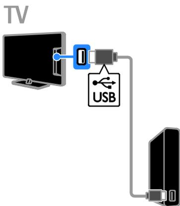
Подключите жесткий диск USB к телевизору с помощью кабеля USB.
