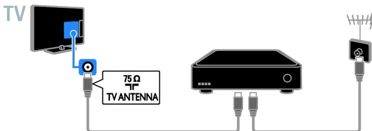
Подключите ресивер спутникового или цифрового телевидения к телевизору с помощью кабеля HDMI.
