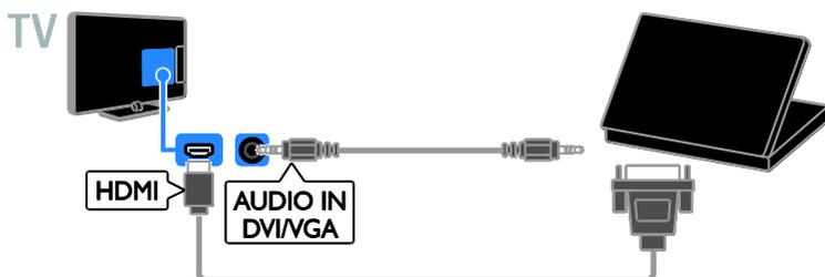
Подключите компьютер к телевизору с помощью кабеля VGA и аудиокабеля.
