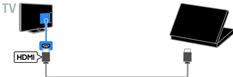
Подключите компьютер к телевизору с помощью кабеля DVI-HDMI и аудиокабеля.
