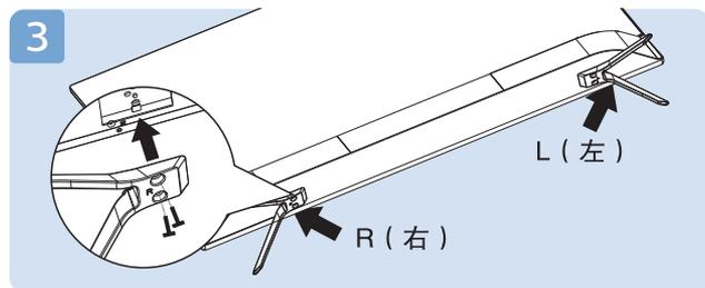
\* 将底座按照图示对齐放置（注意区分左右支撑），“R”、“L”在底座上有标识。
