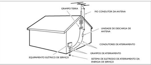
Nota para o instalador de TV a cabo: Este lembrete é fornecido a todos os instaladores de sistema CATV (TV a Cabo) para que tenham atenção as orientações para um aterramento adequado e, em particular, especifica que o cabo terra deve ser conectado ao sistema de aterramento do edificio, o mais próximo possível do ponto de entrada do cabo.
