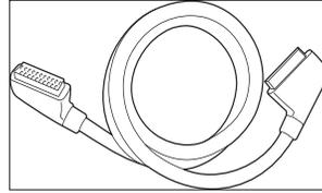
El euroconector combina las señales de audio y vídeo en un solo cable. Las señales de audio son en estéreo, mientras que las de vídeo pueden ser compuestas o de calidad S-vídeo. El euroconector no admite el vídeo de alta definición y es analógico. Con el televisor se proporcionan dos euroconectores, EXT 1 y EXT 2.
