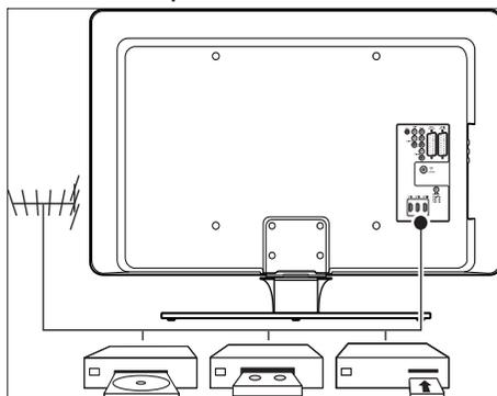
Utilice los conectores posteriores del televisor para conectar la antena y los dispositivos permanentes, como un reproductor de discos de alta definición, un reproductor de DVD o un vídeo (consulte 'Conexión de los dispositivos' en la página 40).
