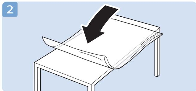
\* 在平整台面铺上软布，将电视机屏幕朝下，下巴置于台面外，然后放置于在台面。
