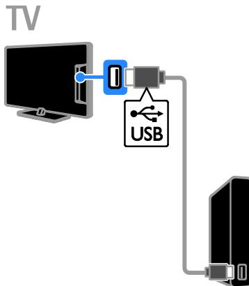
用 USB 电缆将 USB 硬盘连接到电视。
