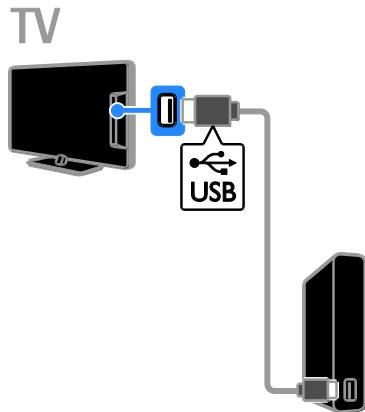
1. 将 USB 硬盘直接连接到电视机上，如果您打算在以后连接其它 USB 设备，请通过 USB 集线器连接该 USB 硬盘。
