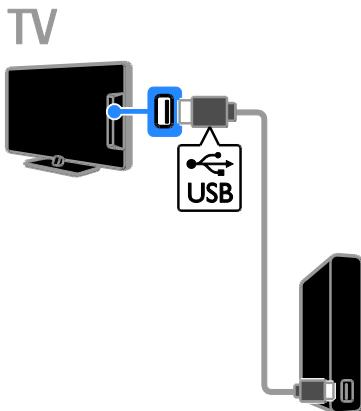
1. 将 USB 硬盘直接连接到电视机上, 如果您打算在以后连接其它 USB 设备, 请通过 USB 集线器连接该 USB 硬盘。
