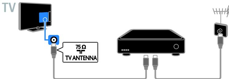
用 HDMI 电缆将卫星或数字电视接收器连接到电视。
