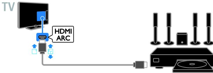
用 HDMI 电缆和同轴音频电缆将家庭影院连接到电视。
