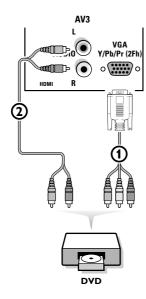
Conecte o equipamento com saída **2Fh YPbPr** ao conector **VGA** 1 (através do cabo VGA para CVBS fornecido). Conecte os cabos de **AUDIO** L e R 2 do equipamento, ao conectores L e R no **AV3**.
