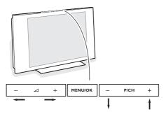
Se o controle remoto estiver danificado ou perdido, sempre será possível alterar determinados ajustes com as teclas localizadas na parte superior do televisor.
