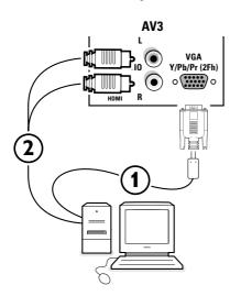
Permite conectar seu computador via conector **VGA** em **AV3** ou conector **HDMI** (veja conector HDMI).
