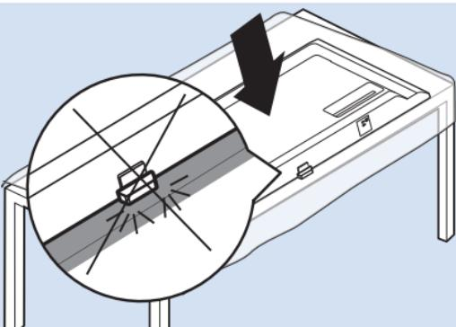
\*请将电视机底部边缘靠近台面边缘，将下巴放置于台面外。
