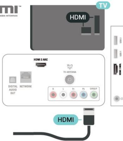
Wenn der DVD-Player über HDMI angeschlossen ist und über EasyLink CEC verfügt, können Sie den Player mit der Fernbedienung des Fernsehers steuern.
