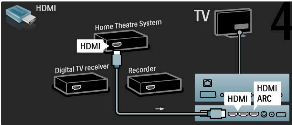
Если соединение HDMI-ARC на устройстве и телевизоре не используется, добавьте цифровой аудиокабель (коаксиальный cinch).
