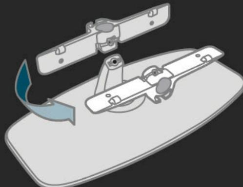
Установите штангу на место и с помощью шестигранного ключа зафиксируйте болт.
