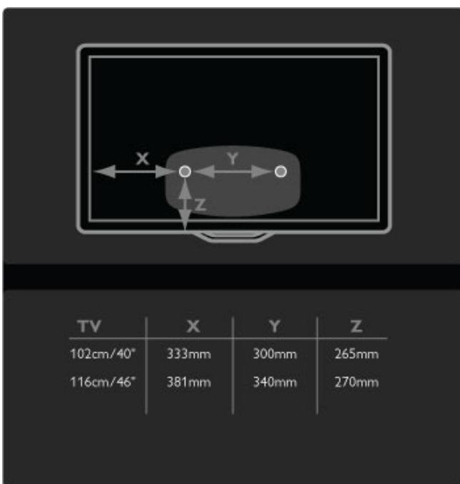
Закрутите два крепежных диска. Используйте винты диаметром не более 6 мм.
