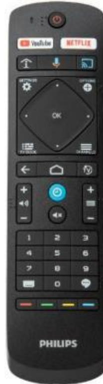
*Hinweise: Frühere Fernbedienungen mit Ziffern funktionieren **NICHT** mit der Fernseherserie xxBDL2114, da der von der Fernbedienung gesendete Code für einige Tasten unterschiedlich ist. Wenn Ihr Kunde auf einer Fernbedienung Zifferntasten benötigt, muss eine der oben genannten Fernbedienungen verwendet werden und kein anderes früheres Modell. Die Ziffern im Menü können über das Profi-Menü aktiviert werden.*
