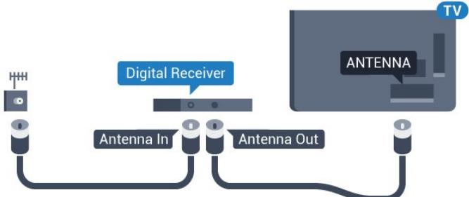
До връзките за антена добавете HDMI кабел, за да свържете цифров приемник (Set-top box) с телевизора. Или можете да използвате SCART кабел, ако цифровият приемник няма HDMI връзка.
