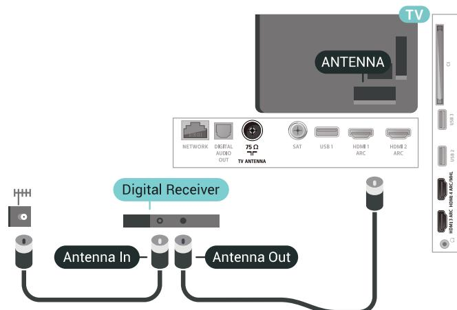
След антенните връзки добавете HDMI кабел, за да свържете цифровия приемник (Set-top box) към телевизора.
