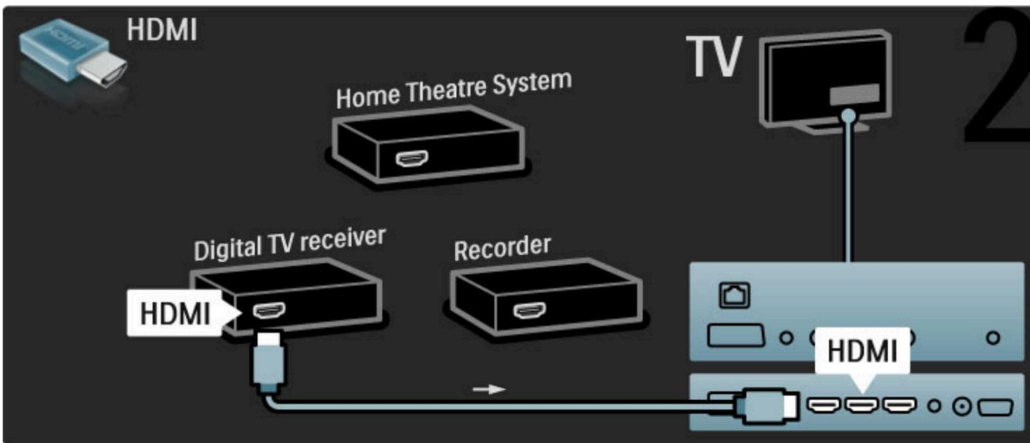
Потім для під'єднання рекордера до телевізора використайте кабель HDMI.
