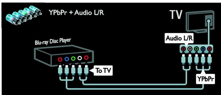
Conecte el reproductor de discos con un cable compuesto (Y Pb Pr) y un cable de audio L/R al televisor.
