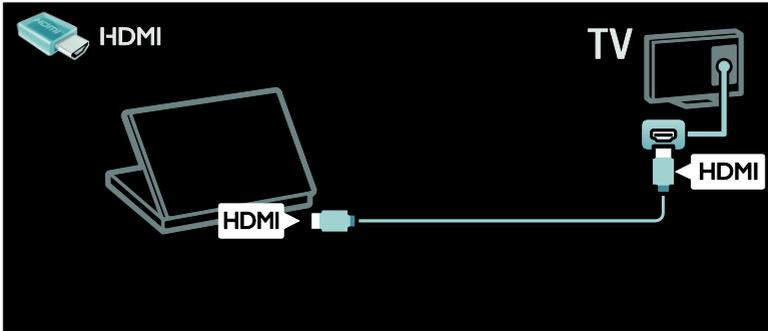
Conecte la computadora con un cable DVI-HDMI al televisor.
