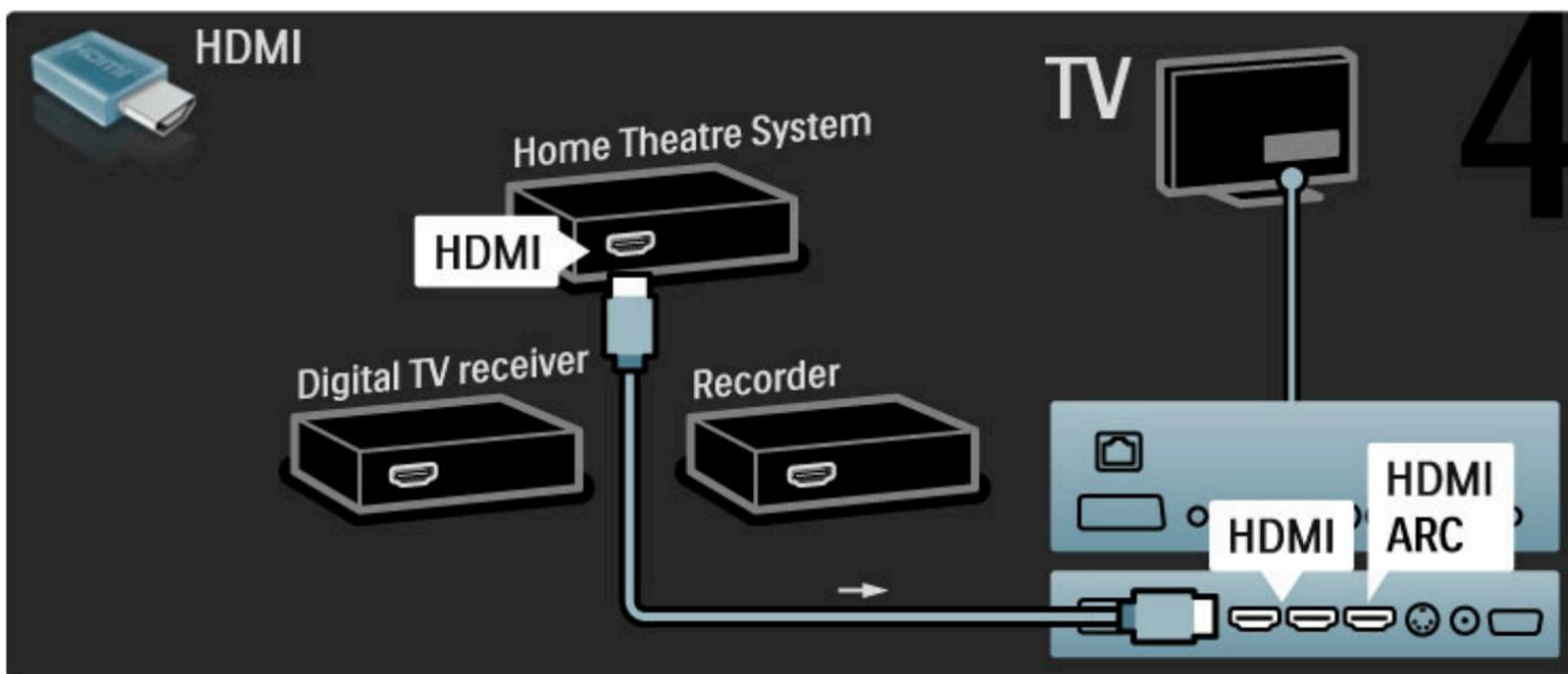
Ако не използвате HDMI-ARC връзката на телевизора и устройството, добавете цифров аудио кабел (чинч коаксиален).
