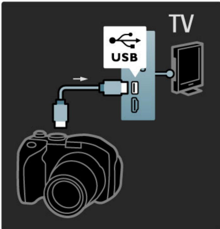
Ако списъкът със съдържанието на фотоапарата не се появи автоматично, може би трябва фотоапаратът ви да се настрои за прехвърляне на съдържанието с PTP (Picture Transfer Protocol - Протокол за прехвърляне на снимки). Прочетете ръководството за потребителя на цифровия фотоапарат.
