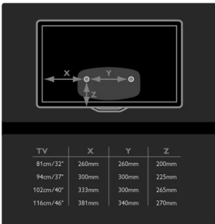
Закрепете двата монтажни диска. Използвайте винтове с диаметър максимум 6 мм.
