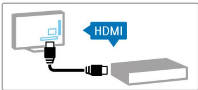
Χρησιμοποιήστε τη σύνδεση **HDMI™** για να συνδέσετε μια συσκευή αναπαραγωγής DVD, μια συσκευή Blu-ray Disc ή μια κονσόλα παιχνιδιών.
