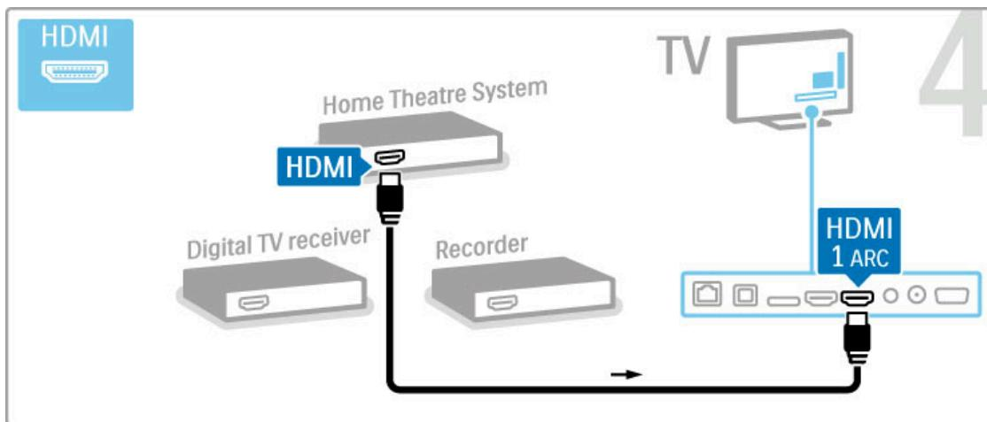
Εάν δεν χρησιμοποιήστε τη σύνδεση HDMI-ARC στην πλεόραση και τη συσκευή, χρησιμοποιήστε ένα καλώδιο ψηφιακού ήχου (οπτική).
