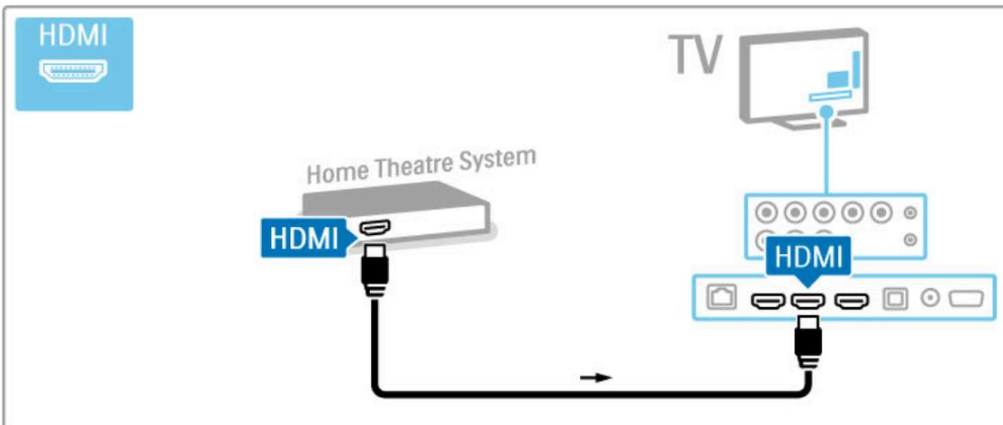
Si utiliza conexiones HDMI-ARC en el televisor y en el dispositivo, no necesitará ningún otro cable. De lo contrario, la información que se indica a continuación puede ser útil.
