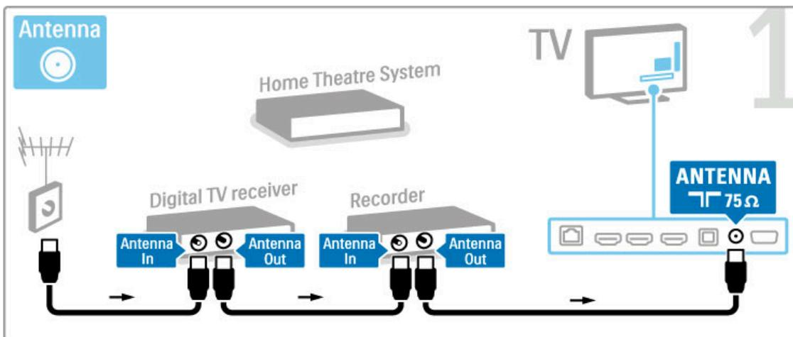
A continuación, utilice un cable HDMI para conectar el receptor digital al televisor.
