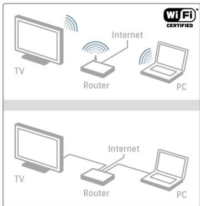
Si conecta el router mediante cables, necesitará un cable de red (Ethernet).
