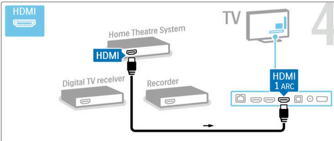
Si no utiliza la conexión HDMI-ARC para conectar el dispositivo al televisor, use un cable de audio digital (óptica).
