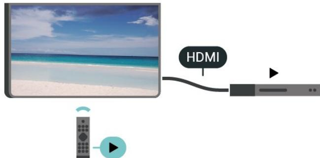
HDMI CEC (Контрол на потребителска електроника) трябва да бъде включено както в телевизора, така и в свързаното устройство.
