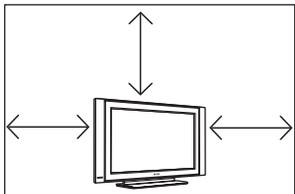
Αφήστε τουλάχιστον 10 εκατοστά ελεύθερου χώρου γύρω από κάθε πλευρά της συσκευής της τηλεόρασης για να επιτρέπεται σωστός εξαερισμός. Τοποθετήστε την συσκευή πάνω σε σταθερή, επίπεδη επιφάνεια. Ποτέ μην καλύπτετε με ύφασμα ή οποιοδήποτε άλλο υλικό τις υποδοχές για εξαερισμό της τηλεόρασης. Μπορεί να προκαλέσει υπερθέρμανση. Μην βάζετε τίποτα μέσα στις οπές εξαερισμού. Εάν κάτι μεταλλικό ή εύφλεκτο μπει σ' αυτές τις τρύπες, μπορεί να προκαλέσει φωτιά ή ηλεκτροπληξία.
