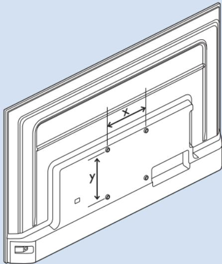
温馨提示：壁挂安装时，请先将机器壁挂锁附位置的螺丝
