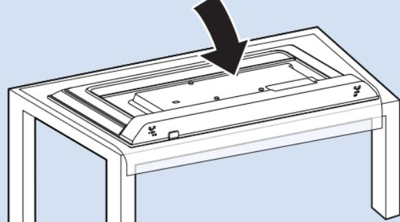
\*请将电视机底部边缘靠近台面边缘，将下巴放置于台面外约5cm。
