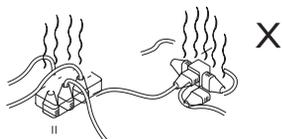
Не подключайте очень много оборудования к одной розетке, поскольку это может вызвать чрезмерную нагрузку и привести к пожару или к короткому замыканию.
