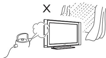
Чтобы предупредить возникновение пожара или короткого замыкания, не подвергайте телевизор воздействию дождя или сырости.
