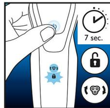
Une fois les têtes de rasage remplacées, vous pouvez réinitialiser le témoin de remplacement en appuyant sur le bouton marche/arrêt pendant plus de 7 secondes. Si vous ne le faites pas, le voyant de remplacement s'éteindra automatiquement au bout de 9 rasages.
