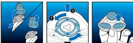
1. Ouvrez le rasoir en appuyant sur le bouton de déverrouillage ; 2. Retirez les bagues de fixation en les tournant dans le sens inverse
