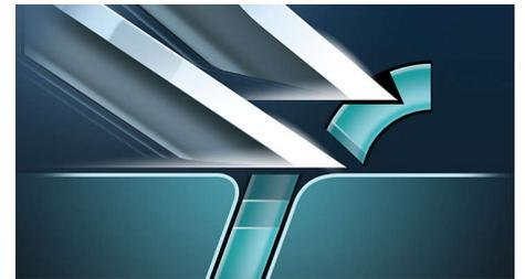
Rasez-vous de plus près avec le système Super Lift&Cut à deux lames. La première lame soulève chaque poil, tandis que la seconde assure un rasage confortable sous le niveau de la peau.
