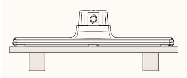
2. Placez le téléviseur sur le pied en faisant coïncider le point de montage. Laissez ensuite le téléviseur être entraîné par son poids jusqu'à l'encliquetage.
