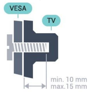
• 32PFS6402 VESA MIS-F 100x100, M4 • 43PUS6432、43PUS6452 VESA MIS-F 200x200, M6 • 49PUS6432、49PUS6452 VESA MIS-F 400x200, M6 • 55PUS6432、55PUS6452 VESA MIS-F 400x200, M6 准备 先卸下电视背面螺纹衬套中的 4 个塑料螺钉盖。确保用金属螺钉将电视安装至 VESA 兼容支架上,拧入电视螺纹衬套约 10 毫米深。
