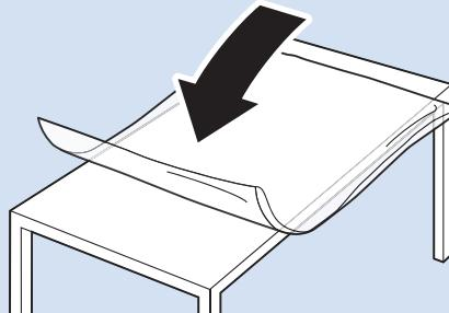
\* 在平整台面铺上软布，将电视机屏幕朝下，下巴置于台面外，然后放置于在台面。
