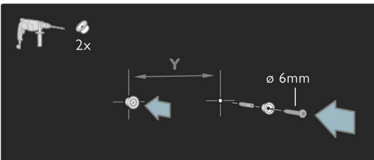
Spodnjo ploščo stojala premaknite na namestitveni ploščici.
