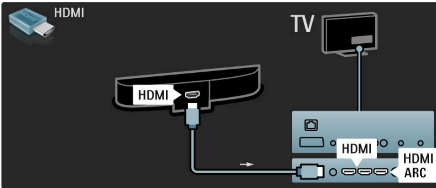
Če uporabljate povezave HDMI-ARC na televizorju in napravi, ne potrebujete nobenega drugega kabla. V nasprotnem primeru berite dalje.
