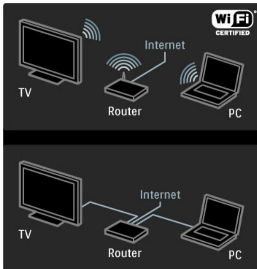
Če uporabljate usmerjevalnik z žičnim priklopom, potrebujete omrežni (ethernetni) kabel.
