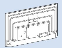
温馨提示:壁挂安装时,请先将机器壁挂锁附位置的螺丝 (已安装)取出,此螺丝非标准壁挂螺丝,请勿使用。
