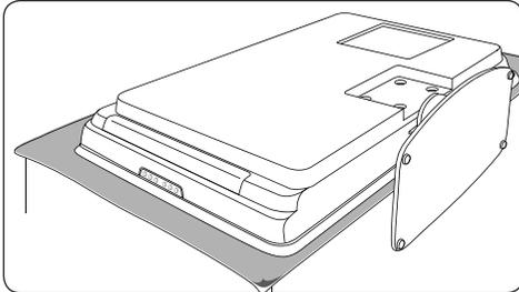
2. Lösen Sie die vier Schrauben, mit denen der Standfuß am Fernsehgerät befestigt ist mithilfe eines Kreuzschraubenziehers (nicht im Lieferumfang enthalten).
