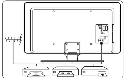
Verwenden Sie die rückseitigen Anschlüsse, um die Antenne und permanent angeschlossene Geräte wie HD-Disc-Player, DVD-Player oder Videorecorder anzuschließen.
