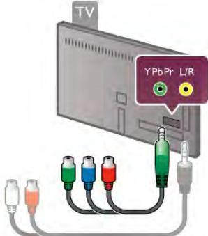
Χρησιμοποιήστε το παρεχόμενο καλώδιο YPbPr για να συνδέσετε τη συσκευή σας. Αντιστοιχίστε τα χρώματα των υποδοχών της σύνδεσης YPbPr (πράσινο, μπλε, κόκκινο) με τα βύσματα του καλωδίου.
