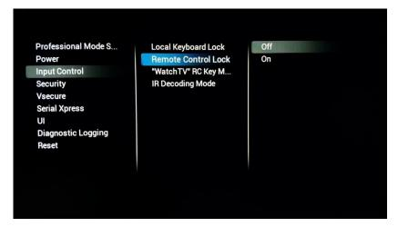
Si se activa [Remote Control Lock] ([On]), el mando a distancia normal ya no funcionará. Puede activarse cuando se usen decodificadores.
