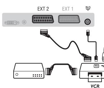
Vykonajte zapojenia uvedené oproti. Používajte kvalitný eurokonektorový kábel.
