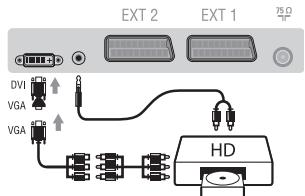
Podłącz urządzenia w sposób pokazany na schemacie.
