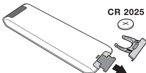
Odstráňte izolačný pásiak z batérie, čím aktivujete diaľkové ovládanie.
