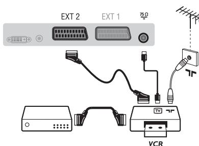
Proveďte zapojení znázorněné na obrázku. Použijte kvalitní kabel SCART.
